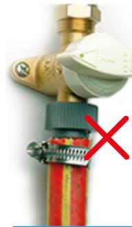
**Non** - Tuyau et raccord d'arrosage montés sur un robinet à pas de vis
